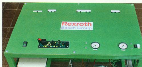
Von oben: Messbuchsen (obere Reihe), Hauptschalter (links unten), Bedienpult, Manometer für den liegenden Kolben, externe Bedienung.
