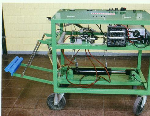
Das Steuerventil und das Hubwerk werden über ein externes Aggregat (nicht im Bild) versorgt. Oben der Verteilerkasten mit den Schaltern.
