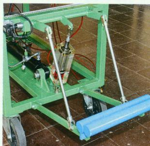
Die Wellenenden (blau) liefern Gewicht zum Senken des Hubwerks. Oben links ist der Positionssensor an der Hubwelle montiert.
